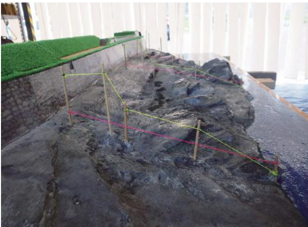
写真 5-1-6 完成模型 岩掘削形状 (黄線：掘削前 赤線：計画掘削ラインより1m上げ)
