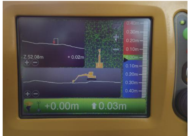
写真 5-1-17 CIM を活用した ICT 施工 (実際の計画掘削ラインまでの高さが表示される)
