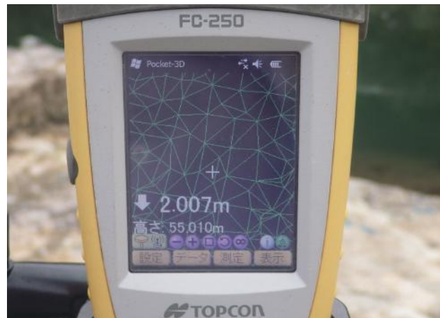
写真 5-1-15 GPS 測量機 (実際の計画掘削ラインまでの高さが表示される)
